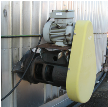
Bituumenimahuti küljele paigaldatud elektriline segisti
